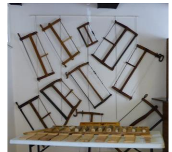
Outils des menuisiers et charpentiers : scies variées, varlope, riflard et autres rabots inlassablement expliqués par Laurent Bellot
